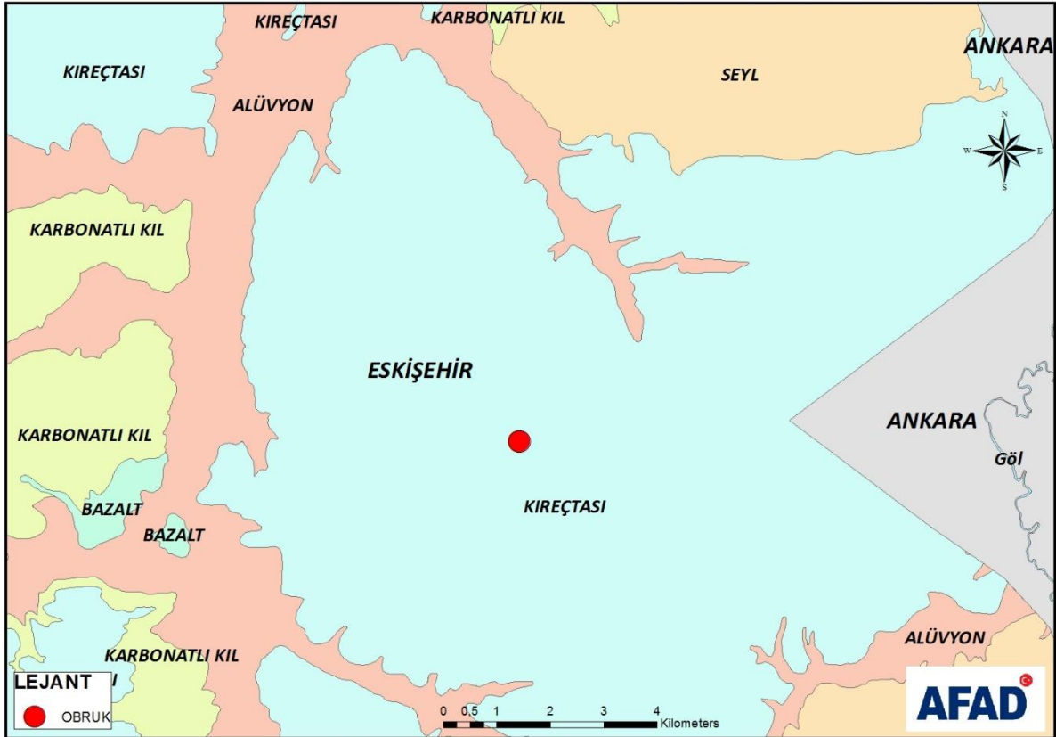
Şekil 2.55 - Sivrihisar Mülk Mahallesi'nde Oluşan Obruğun Litoloji Haritası
